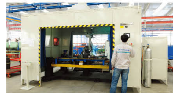
Японское оборудование автоматизированной сварки
